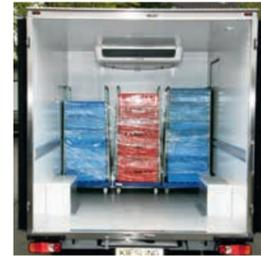
Die niedrige Bauweise, bedingt durch ein spezielles Tiefrahmenchassis, sorgt für einen tiefen Einstieg in Fahrerhaus und Laderaum (ca. 600 mm). Das spart
